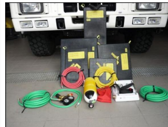
Einsatzbereiche für diese Hebekissen sind Bergungen, Hebearbeiten und das Abdichten von Behältern.
